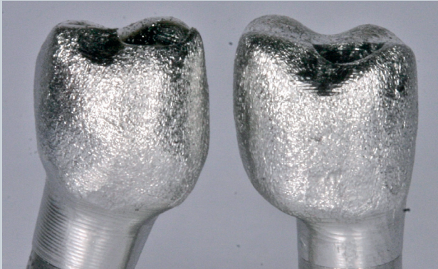
FIG. 33.11 – Uma vez removidos do bloco de metal, os copings são recortados, uniformizados e tratados para aplicação de cerâmica. Aqui encontram-se sobre os análogos laboratoriais.
