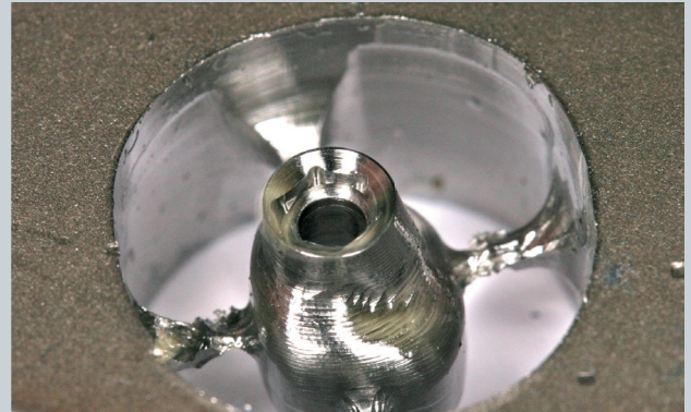
FIG. 33.10 – Bloco em liga de cobalto-cromo com coping usinado fixado. Não há, em nenhum momento, o risco de comprometer as propriedades da liga metálica como acontece em fundições, preservando todas as propriedades dos materiais.
