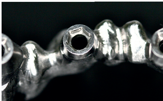
FIG. 33.8 – Há uma limitação no desenho dos antirrotacionais internos aos pilares personalizados, pois o sistema de usinagem utiliza brocas cilíndricas com pontas arredondadas, daí o motivo dos antirrotacionais terem um alívio circular em seus vértices. Nos sistemas de usinagem por tornos CNC, são utilizadas ferramentas em bisel, não brocas, para manter os vértices com canto vivo
